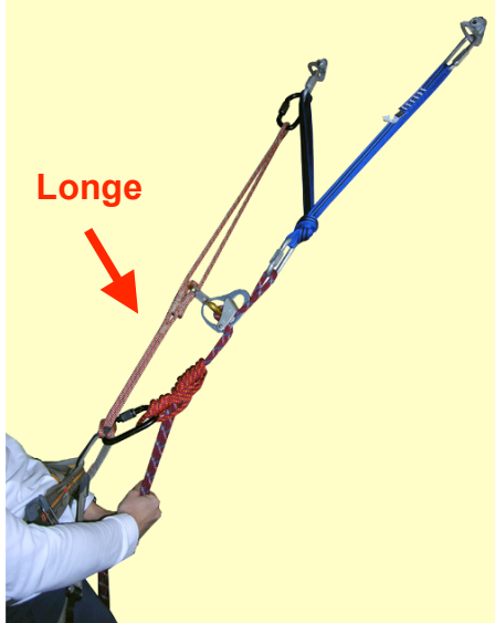
Figure 31. Démonstration du prototype de longe amarrée au relais avant une descente en rappel.
