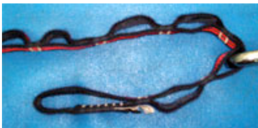
Figure 22. Sangle à boucles fixée par sa deuxième boucle intermédiaire.
