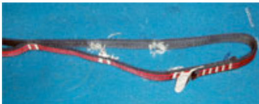
Figure 25. Déchirures des petites boucles d'une sangle à boucles après des chutes de facteur 2.
