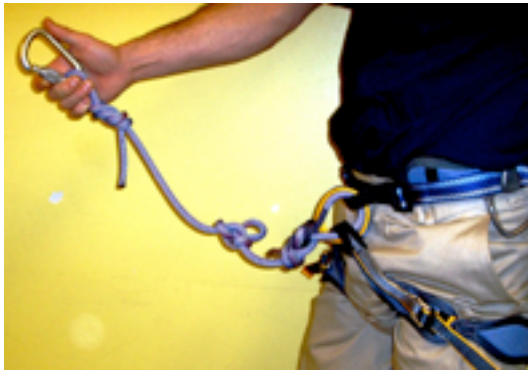
Figure 6. Une longe nouée (fait d'un brin de corde à simple avec un nœud papillon au milieu) fixée au harnais
